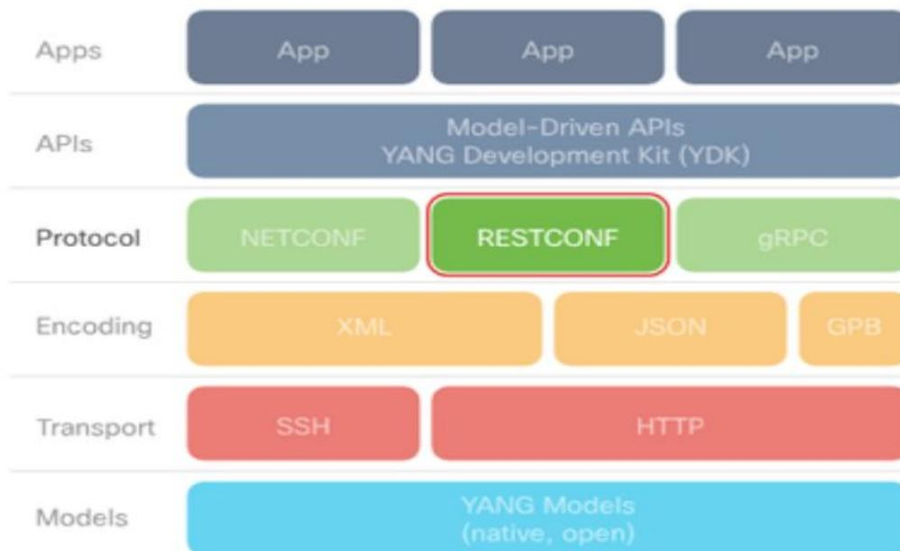
RESTCONF usa data estructurada(XML, JSON) y YANG que provee API's estilo REST, habilitando acceso programable a equipos. Comandos HTTP como GET, PUT, PATCH y DELETE son redireccionados a una RESTCONF API para acceder a los recursos de data representados por modelos YANG.
